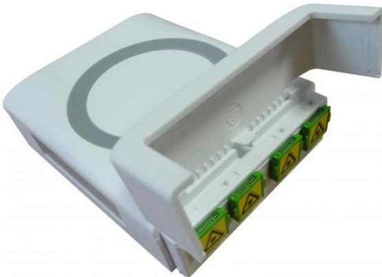
Die Abschlusseinheit in jeder Wohnung sollte mind. 2 Steckerbuchsen SC APC oder LC APC besitzen. In dieser wird das verlegte Kabel auf die verbauten Kupplungen aufgespleißt. Alternativ wie in Punkt 4.3 beschrieben, gibt es diese Abschlusspunkte auch vorkonfektioniert.
